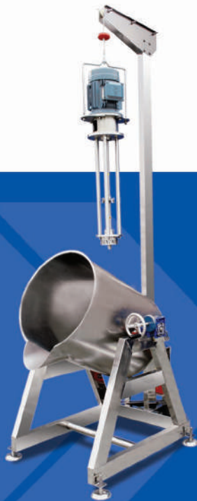
یک نمونه از نصب HSM با مخزن گردان
